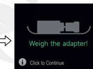
Etape 3 : Pesez l'adaptateur et faites un appui bref pour continuer.
